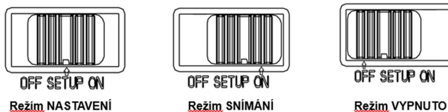
Obrázek 4: Vyobrazení polohy posuvného tlačíka jednotlivých režimů fotopasti
